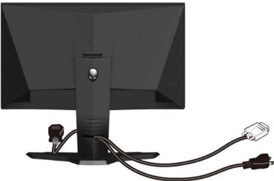
Verwenden Sie nach dem Anbringen aller erforderlichen Kabel an Ihren Monitor und den Computer (siehe [Anschließen Ihres Monitors](#) für Hinweise über das Anschließen der Kabel) den Kabelhalter, um sämtliche Kabel wie oben abgebildet sauber zu verlegen.
